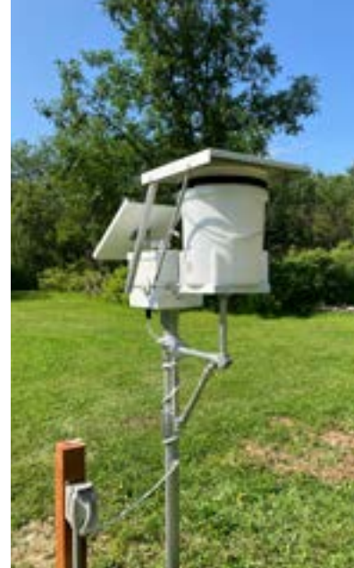
Équipement d'échantillonnage des pluies acides
